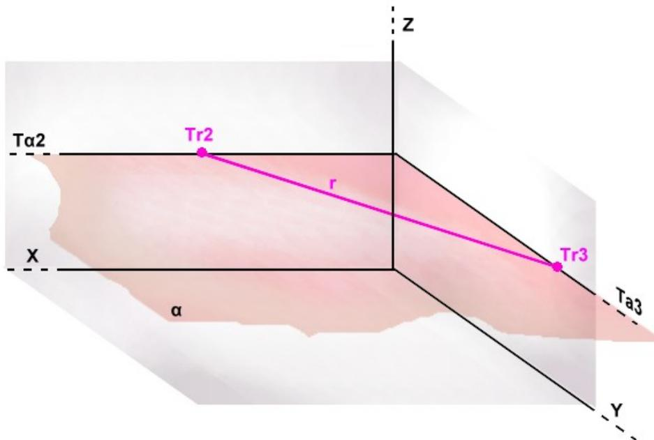
La retta di colore rosa ha le **Tracce** - che raggiungono il PV ed il PL ed ingrandite con un dischetto anch'esso rosa - proprio sopra le tracce nere del piano  $\alpha$ . Due punti della retta - le tracce - appartengono alle tracce del piano e quindi al piano: in questo modo dimostriamo che la retta appartiene ad  $\alpha$ .
