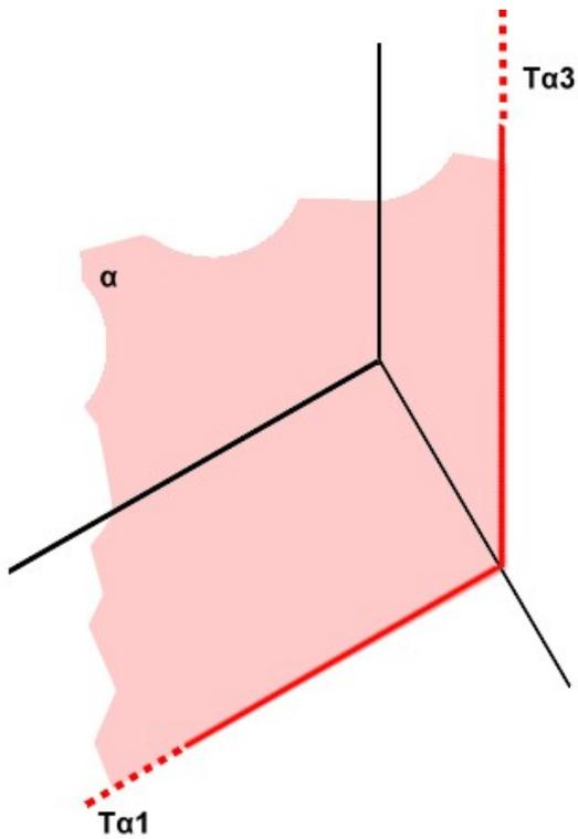
*Se il piano  $\alpha$  è parallelo al PV è necessariamente perpendicolare al PO ed al PL.*
