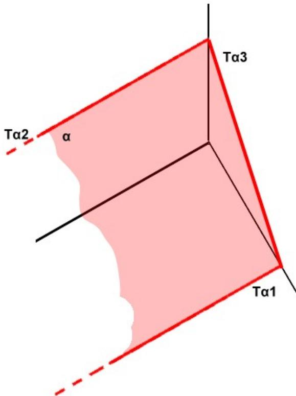
*Se il piano  $\alpha$  è perpendicolare al PL ed inclinato ai restanti piani la traccia inclinata è sul PL. Le altre due tracce saranno perpendicolari al PL.*
