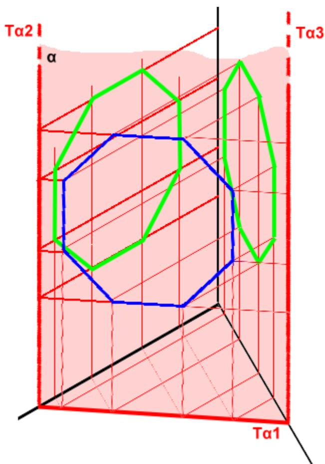
Nella proiezione assonometrica evitiamo di disegnare il piano  $\alpha$  ribaltato, le sue tracce e l'ottagono ribaltati.
