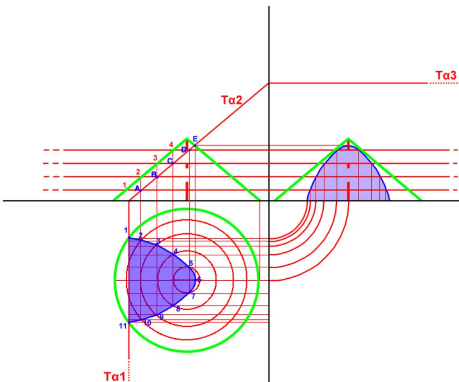
10. Sul PV ribaltiamo le tracce  $T\alpha_1$  e  $T\alpha_3$  che sono perpendicolari alla traccia  $T\alpha_2$ . Tali tracce ribaltate prendono nome -  $(T\alpha_1)$  e  $(T\alpha_3)$ .
