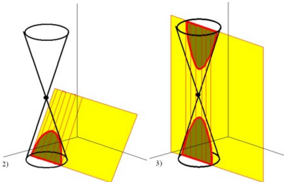
Fig. 2 e Fig. 3 - Sezione di un cono con determinazione di una curva a Parabola e Sezione di un cono con determinazione di una curva ad Iperbole (a destra).
