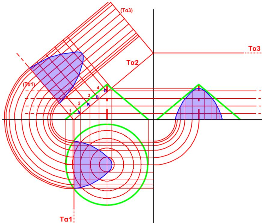
12. Tracciamo le parallele di  $T\alpha_2$  partendo dai punti che abbiamo realizzato su  $(T\alpha_1)$ .
