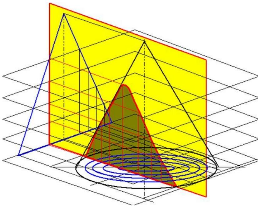
Assonometria isometrica di un cono poggiate sul PO sezionato da un piano alfa perpendicolare al PO, con determinazione di una iperbole.
