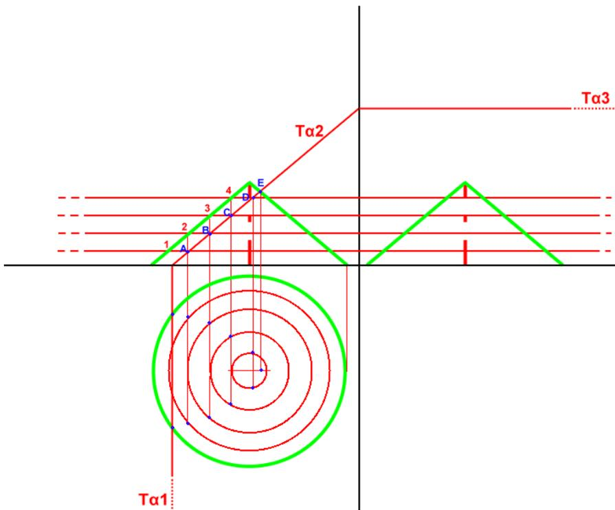
8. Il vertice della parabola deriva dalla perpendicolare dal punto E in figura sino al diametro orizzontale della circonferenza minore. I punti blu nel disegno sopra riportato indicano la proiezione della parabola derivante da una sezione conica sul PO.
