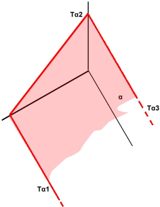
*Se il piano  $\alpha$  è perpendicolare al PV ed inclinato ai restanti piani la traccia inclinata è sul PV. Le altre due tracce saranno perpendicolari al PV.*
