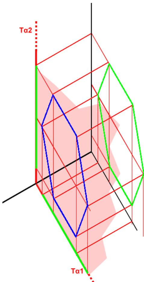
**△ - 4. Proiezioni ortogonali di un ottagono regolare (misure a piacere) appartenente ad un piano  $\alpha$  perpendicolare al PO ed inclinato a piacere ai restanti piani**
