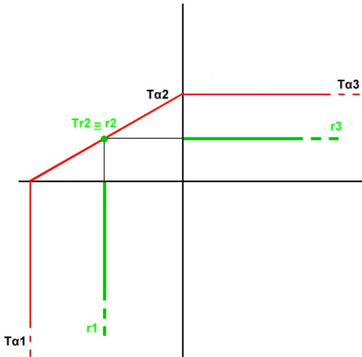
Anche in questa figura possiamo notare che la retta di colore blu indicata con la retta  $r$  è perpendicolare alla traccia, questa volta la  $T\alpha_2$ . La retta crea con la traccia di  $\alpha$  una sua propria traccia che si chiama  $Tr_2$  ossia **Traccia di retta col piano 2** (il piano 2 è sempre il piano verticale).
