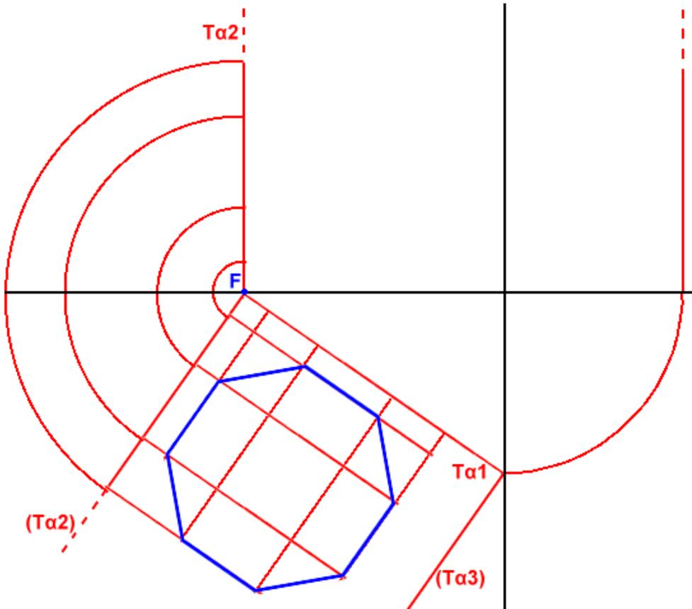
j. Lanciamo le parallele di LT (ricordiamo che LT è la linea di terra) delle tracce che ora sono su  $T\alpha_2$ ; lanciamo anche le perpendicolari di LT partendo dalla  $T\alpha_1$ ; dalle medesime tracce della  $T\alpha_1$  lanciamo anche le parallele di LT e poi le ribaltiamo sino a raggiungere il piano laterale lì dove disegniamo le perpendicolari di LT (figura successiva);
