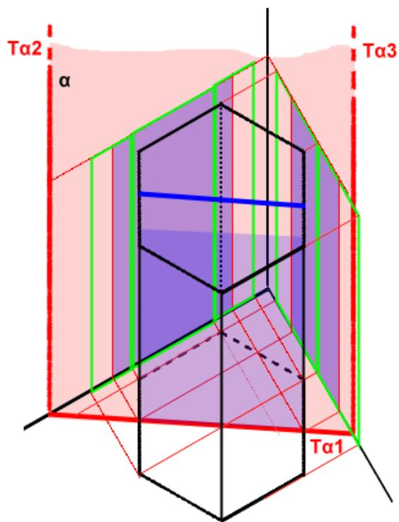
**Δ** - 2. Sezione di prisma esagonale determinato da un piano  $\alpha$  perpendicolare al PV ed inclinato ai restanti piani
