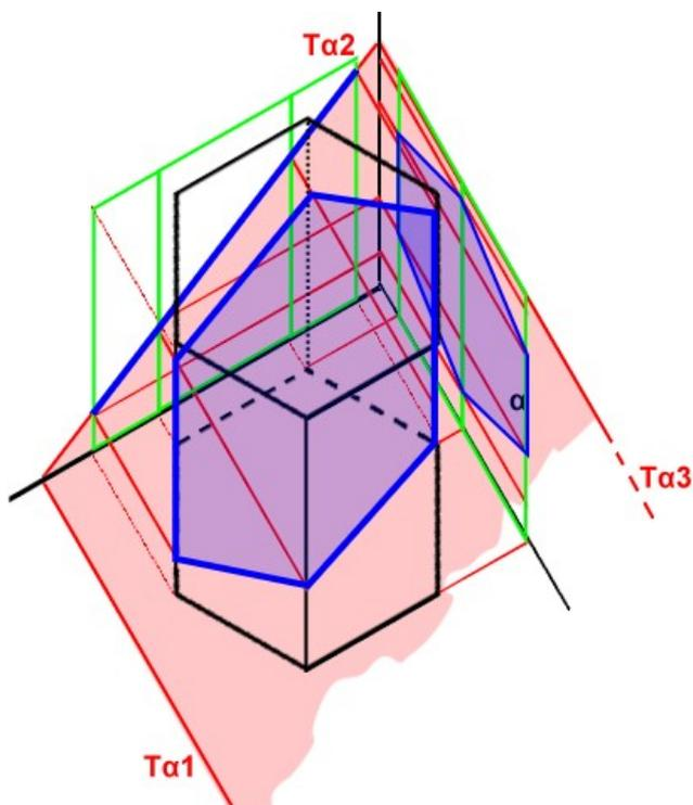
**Δ** - 3. Sezione di piramide esagonale determinata da un piano  $\alpha$  perpendicolare al PV ed inclinato ai restanti piani
