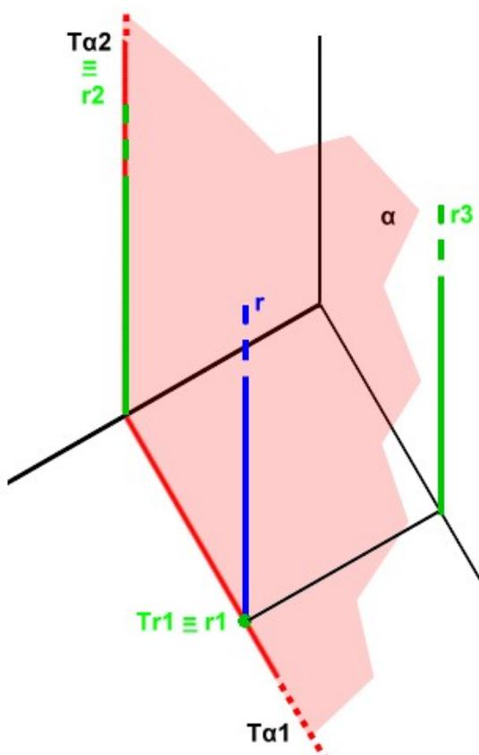
Poiché la retta è in posizione normale rispetto al PO, la proiezione sul PO della retta è un punto che coincide con la traccia  $Tr1$  della retta stessa. La proiezione sul PV cade sulla traccia  $T_{\alpha 2}$  e quindi coincide con essa. Nell'immagine vediamo la proiezione  $r2$  di colore verde sovrapposta alla traccia  $T_{\alpha 2}$  di colore rosso.
