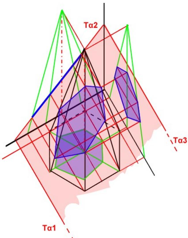
**Δ** - 4. Sezione di piramide esagonale determinata da un piano  $\alpha$  perpendicolare al PL ed inclinato ai restanti piani
