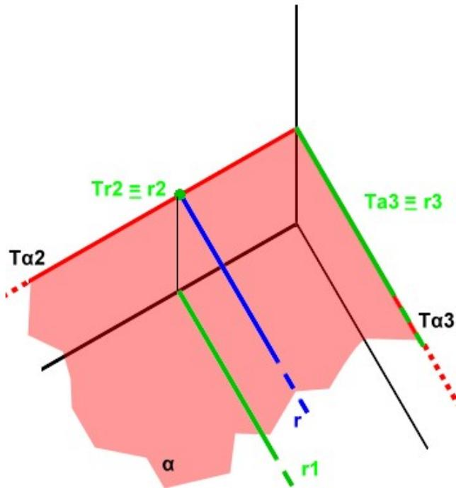
La retta "r" è parallela al PO ed al PL, ossia perpendicolare al PV. La retta "r" ha la traccia Tr2 che è collocata sopra la traccia Ta2 del piano  $\alpha$  perché r appartiene al piano  $\alpha$ .
