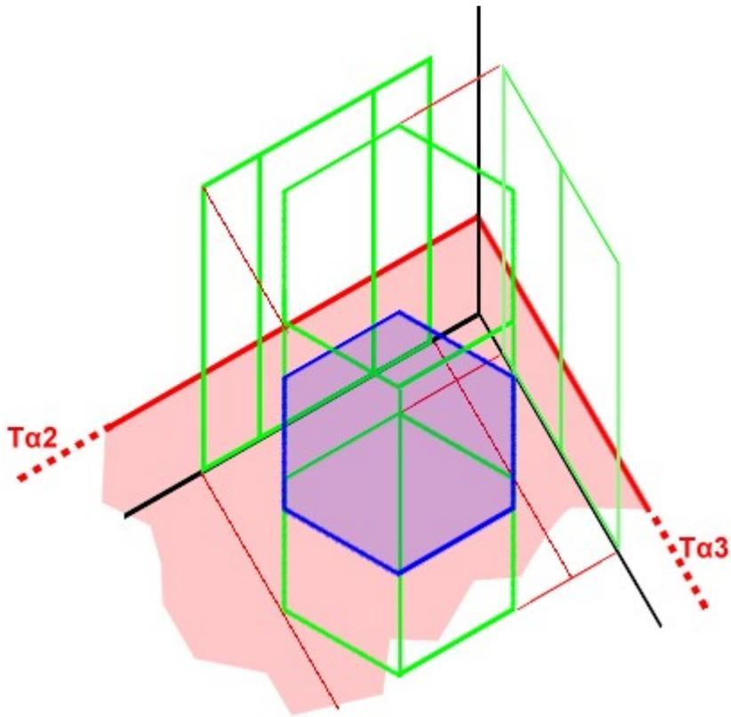
**△** - 2. Sezione di piramide regolare a base esagonale poggiate sul PO; piano sezionante  $\alpha$  parallelo al PO
