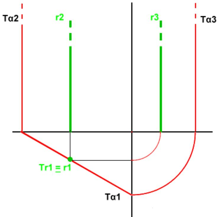
**Δ** - 2. Retta  $r \perp$  al PV ed  $\in$  al piano  $\alpha$  anch'esso  $\perp$  al PV ed inclinato ai restanti piani.
