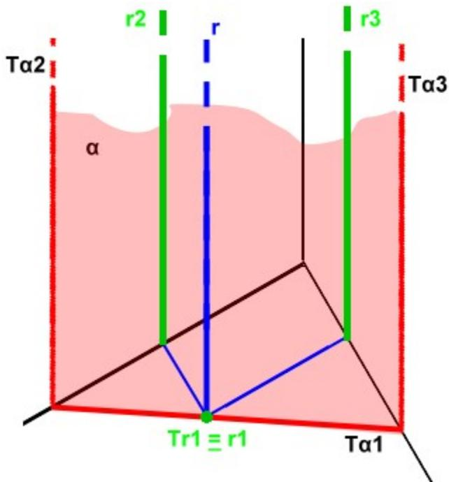
Possiamo notare che la retta di colore blu indicata con il simbolo "r" è perpendicolare alla traccia  $T\alpha_1$ . Con essa crea una sua propria traccia che si chiama  $Tr_1$  ossia *Traccia di retta col piano 1* (il piano 1 è sempre il piano orizzontale).
