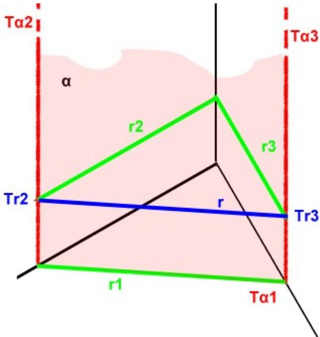
$\Delta$  - 5. Retta inclinata  $\in$  al piano  $\alpha \perp$  al PV ed inclinato ai restanti piani
