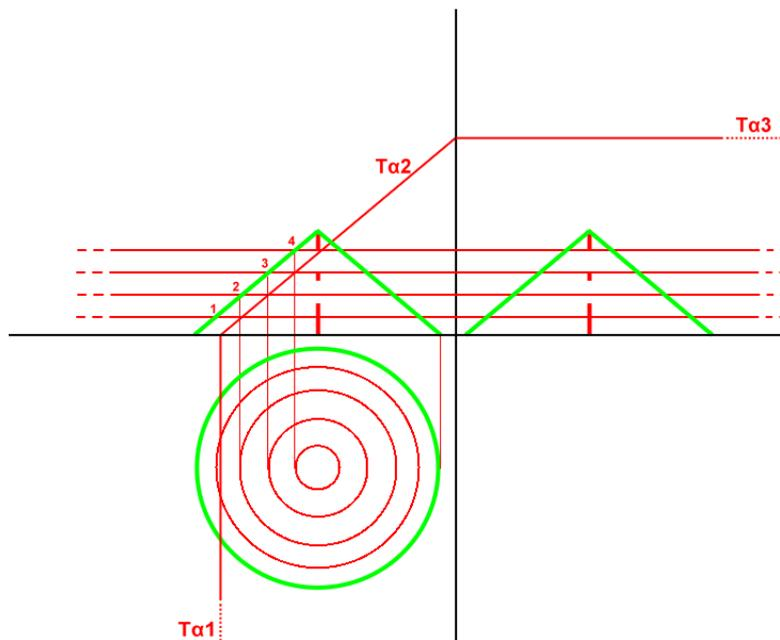
6. Nel disegno sopra riprodotto i cerchi concentrici rossi visibili sul PO sono le sezioni del cono determinate dai quattro piani ausiliari che sul PV incontrano il profilo verde del cono e determinano i punti 1, 2, 3, e 4.
